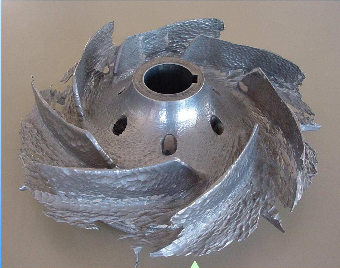
*Corrosion-érosion, après trois semaines d'utilisation, d'une roue turbine en acier inoxydable 316L en milieu acide sulfurique (+particules en suspension)*
