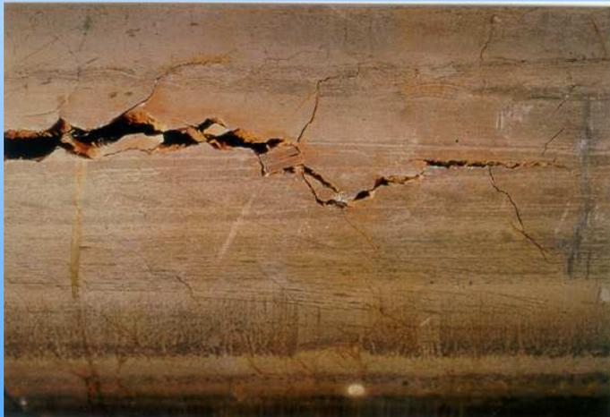
*Corrosion sous contrainte d'un tube en acier inoxydable en présence de quelques ppm de chlorures*
